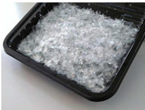
Para el material PET, si el lavado ha sido eficiente, no es necesario un posterior proceso de extrusión granceado. Se comercializa como escama (detalles de prevención en ficha 19.9).
